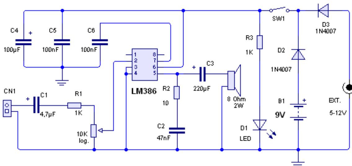
El LM386, con sus variantes: LM386N-1, LM386N-3 y LM386N-4, es un pequeño amplificador de bajo consumo y aceptable calidad con el que podemos conseguir una potencia del orden de unos 700mW utilizando una alimentación de 9 voltios y un altavoz de 8 Ohmios.
